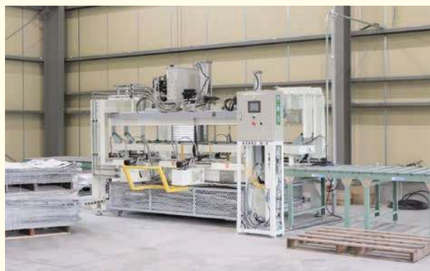
▲フレーム外し装置
