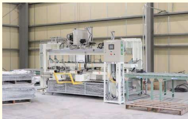
▲フレーム外し装置
